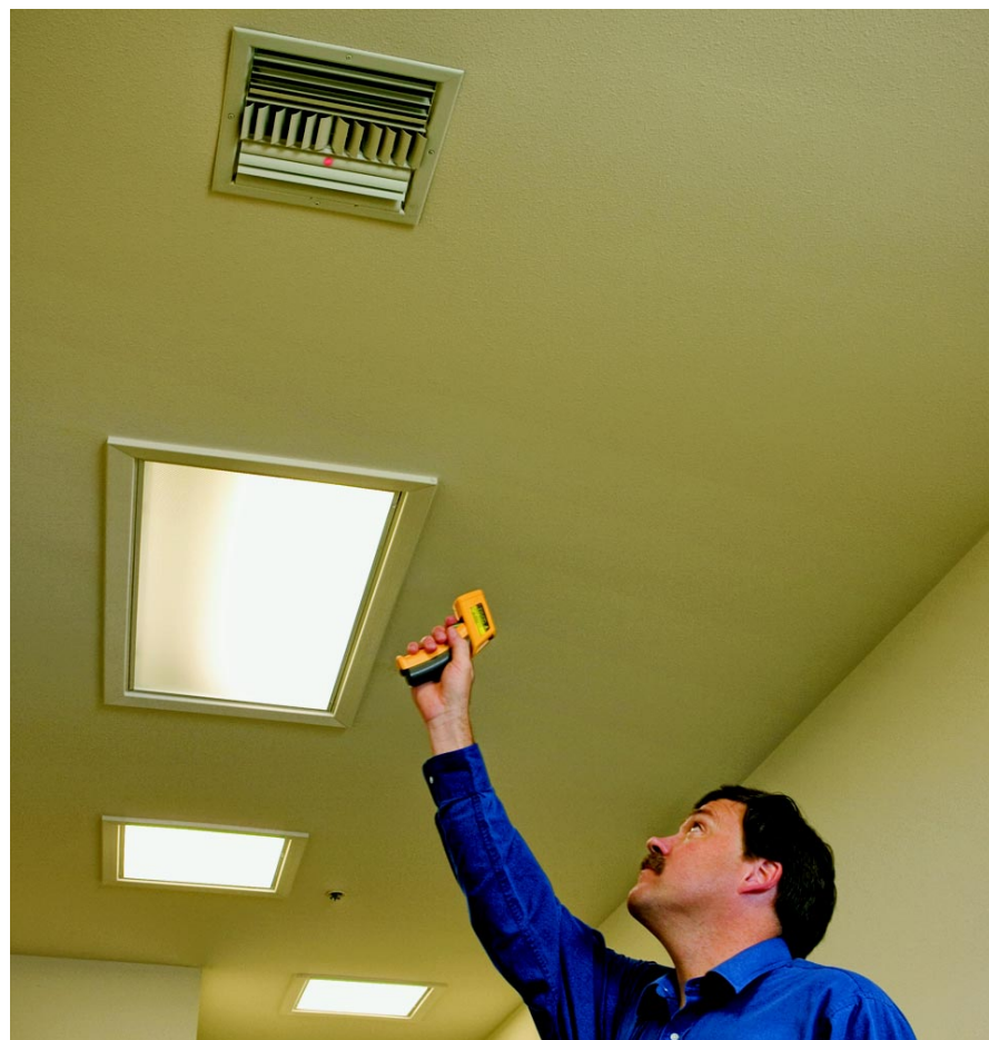
使用非接触式红外测温仪测量无法接触的目标。
